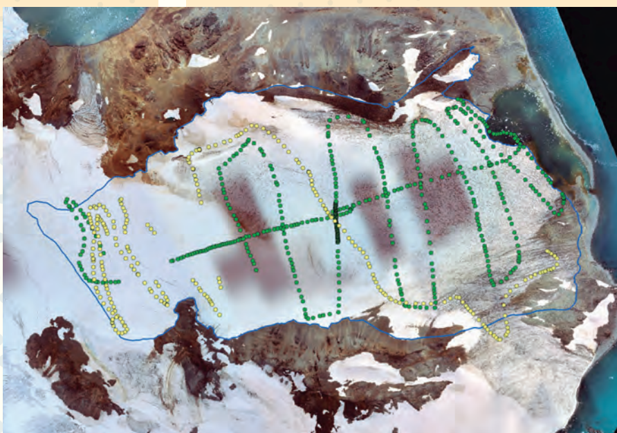
Figura 2. Exploración mediante GeoRadar en el glaciar Znosko en el ANTAR XXVI (líneas verdes) y en la expedición ANTAR XXVII (líneas amarillas). (Fuente: SENAMHI/ANA).
